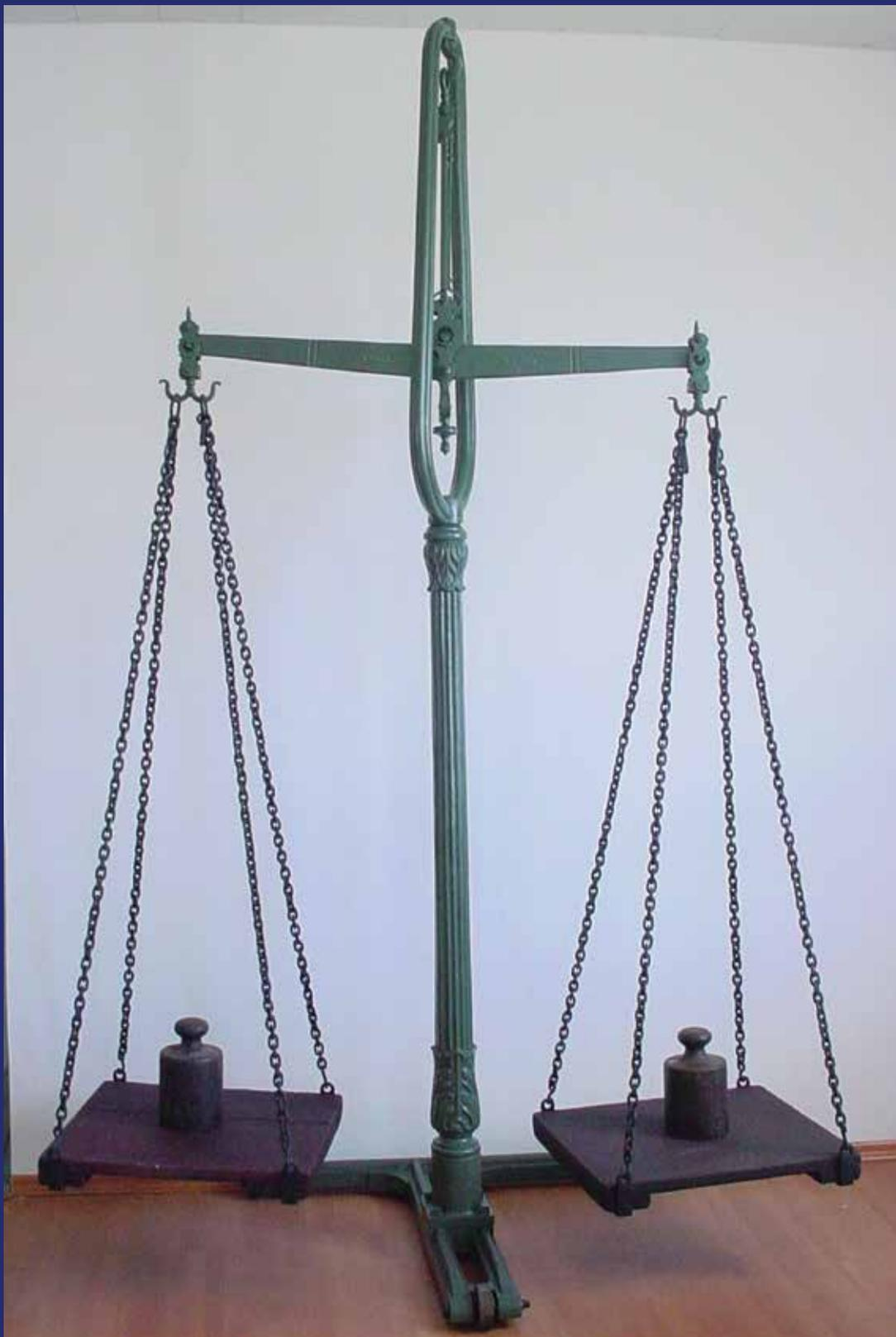
Balança para pesagem de sacas de café. Pesos de 20 kg em ferro fundido (séc. XIX).
