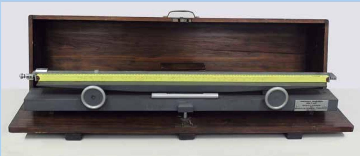
Acima: Metro comercial verificado em um comparador transversal dotado de régua calibrada, com a qual o metro é comparado.
