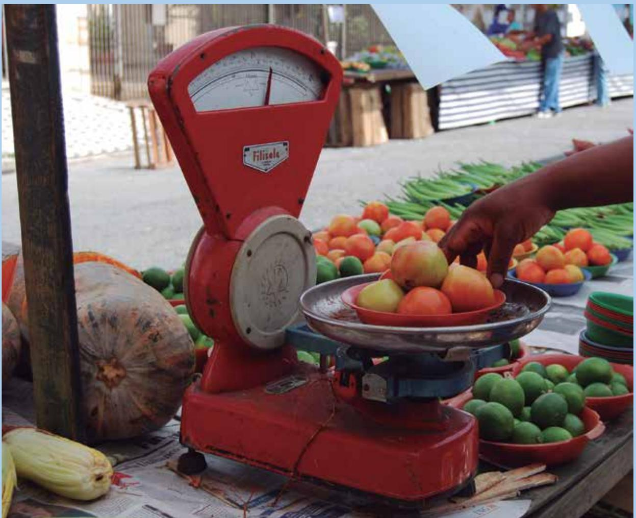
Balança usada em feira livre, operada irregularmente. Observe os calços de madeira sob os pés, que alteraram o nível do instrumento e o resultado da medição. O prato da balança contém terra e o produto é pesado dentro de uma bandeja de plástico. Note-se também a ausência do vidro de proteção da escala, que permite a manipulação do ponteiro.
