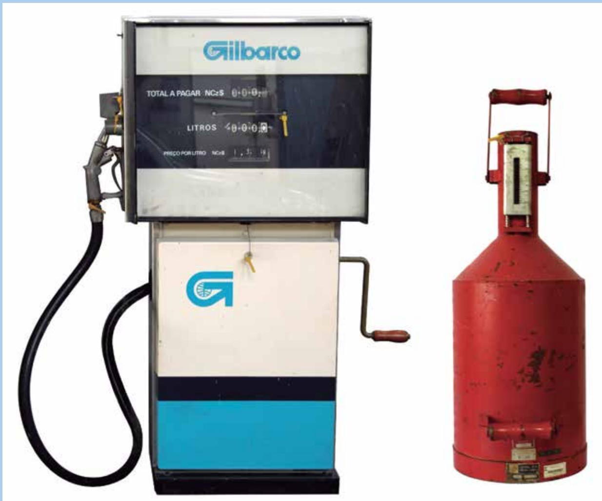
Esquerda: Bomba de combustível eletromecânica em uso nos anos 1970. Note-se a manivela acoplada ao instrumento e utilizada para fazê-lo funcionar em caso de interrupção do fornecimento de energia elétrica.
