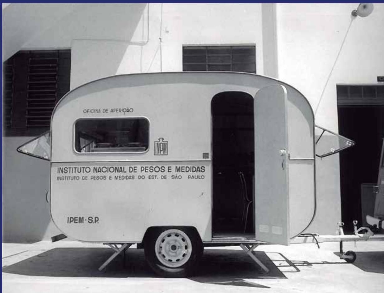
Unidade móvel de aferição. O reboque era provido de ferramentas, instrumentos e padrões que possibilitavam a aferição (verificação metrológica) e o eventual ajuste dos pesos e contrapesos utilizados nas balanças.
