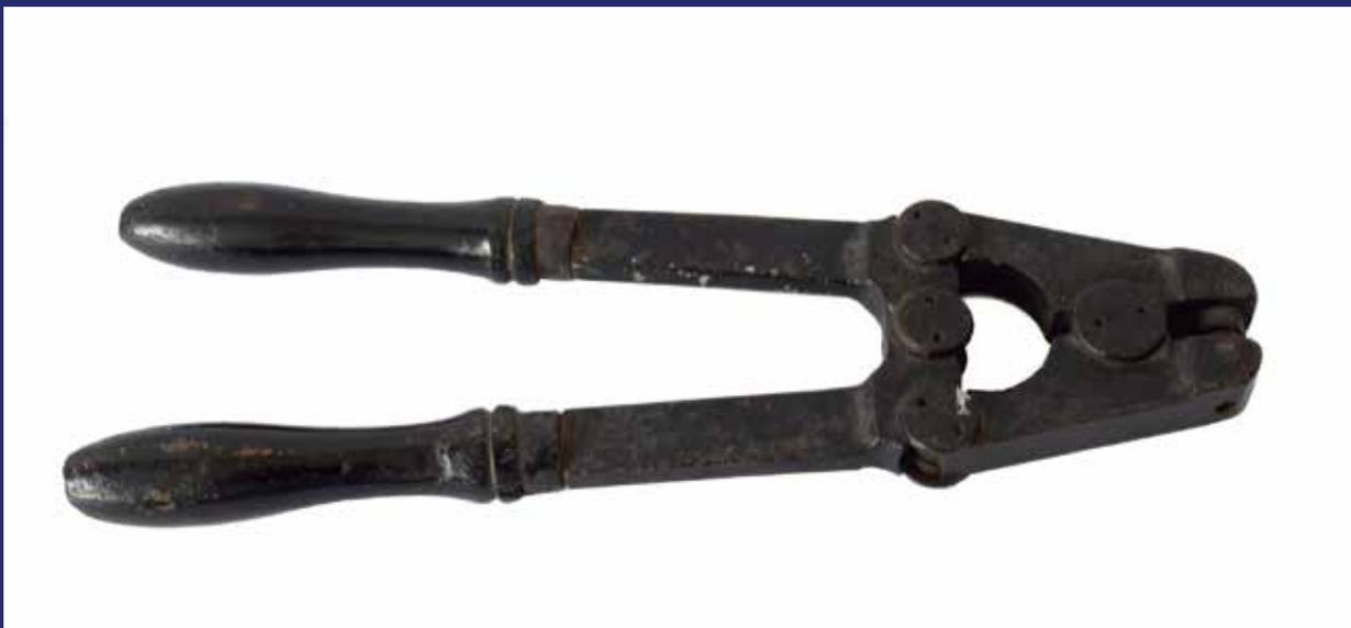
Acima: Alicates de lacração, em ferro, utilizado para pressionar os lacres de chumbo fixados nos acessos aos mecanismos de regulagem do instrumento. O mordente era dotado de sinete que imprimia no lacre a marca da instituição fiscalizadora.
