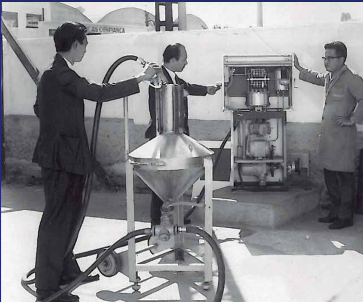
Acima: Verificação inicial em bomba medidora de combustível realizada nas dependências do fabricante. Note-se, em primeiro plano, a medida materializada de volume utilizada no processo.
