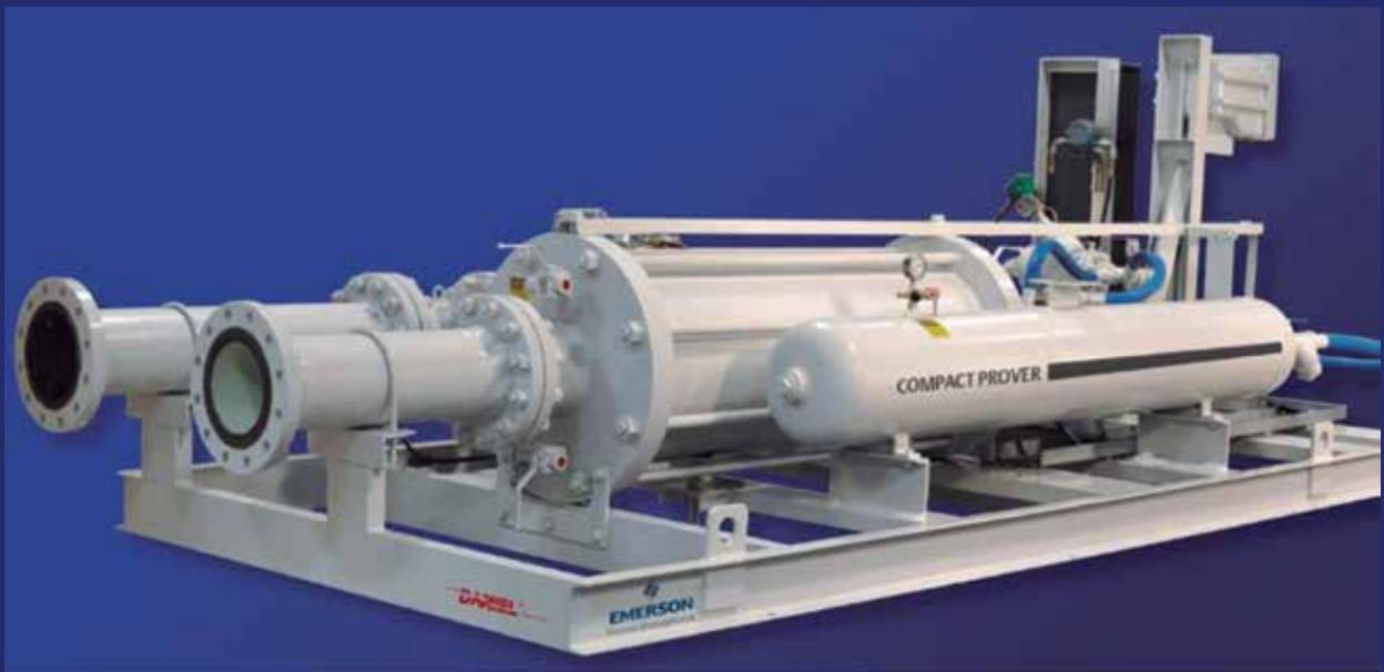
Acima: O Provedor de Deslocamento Mecânico Compacto “Compact Prover” é um instrumento de alta precisão calibrado pelo Ipem-SP o qual, por sua vez, é utilizado para calibrar os medidores de vazão que realizam a medição do volume do petróleo e seus derivados “em linha”, ou seja, enquanto esses produtos passam pela tubulação (oleoduto).
